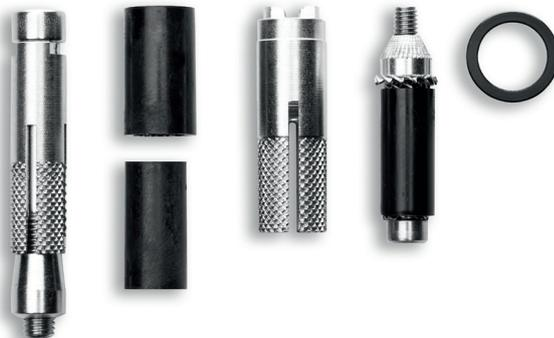
Protezione leva freno. L'inconfondibile design Ducati si unisce all'esperienza di Rizoma in un accessorio sviluppato per migliorare la sicurezza del pilota, prevenendo l'attivazione accidentale del freno anteriore. Dotato di contrappeso sinistro per garantire la massima stabilità. L'anodizzazione di alta qualità mantiene l'aspetto originale nel tempo e il design raffinato esalta l'anima sportiva della moto.
