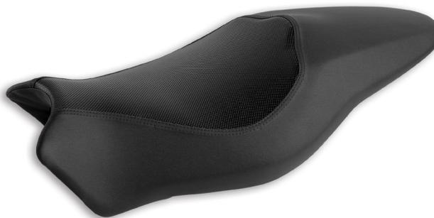
Sella comfort. Più alta di 25 mm, è realizzata con schiumati ad alta densità e rivestita con tessuti tecnici. Ideata per migliorare il comfort del pilota e del passeggero.
