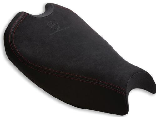
コンフォートライダーシート。標準シートに比べてシート高が20 mm高くなります。高密度フォームと厚みのあるパッド、テクニカルファブリック製カバーを採用し、ライダーをしっかりとサポートしてくれるため、疲れを感じ難く、ライディング時の快適性が大幅に向上します。
