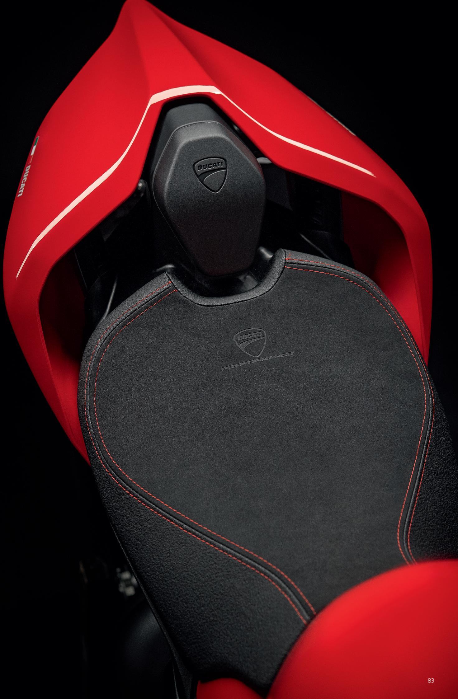
Sella comfort pilota. L'altezza della seduta, maggiorata 20 mm rispetto alla versione di serie, unita alla realizzazione in schiumati più compatti, all'imbottitura più spessa e al rivestimento in tessuto tecnico, offre il massimo sostegno e minimizza l'affaticamento del pilota, migliorando sensibilmente il comfort di guida.
