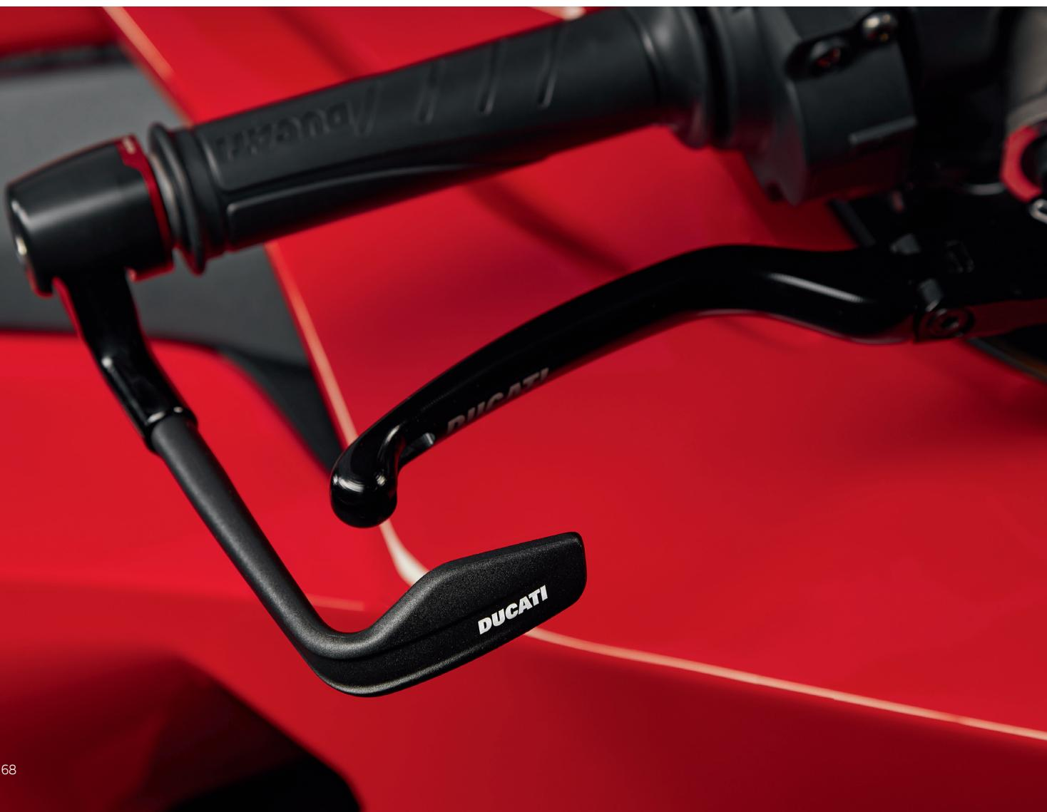
Set adattatori protezione leva freno. L'esperienza Ducati si unisce alla sapiente cura costruttiva di Rizoma in un accessorio studiato per il montaggio del set protezione leva freno e contrappeso sinistro. L'alluminio anodizzato di altissima qualità e finemente lavorato di CNC garantisce un'elevata resistenza.
