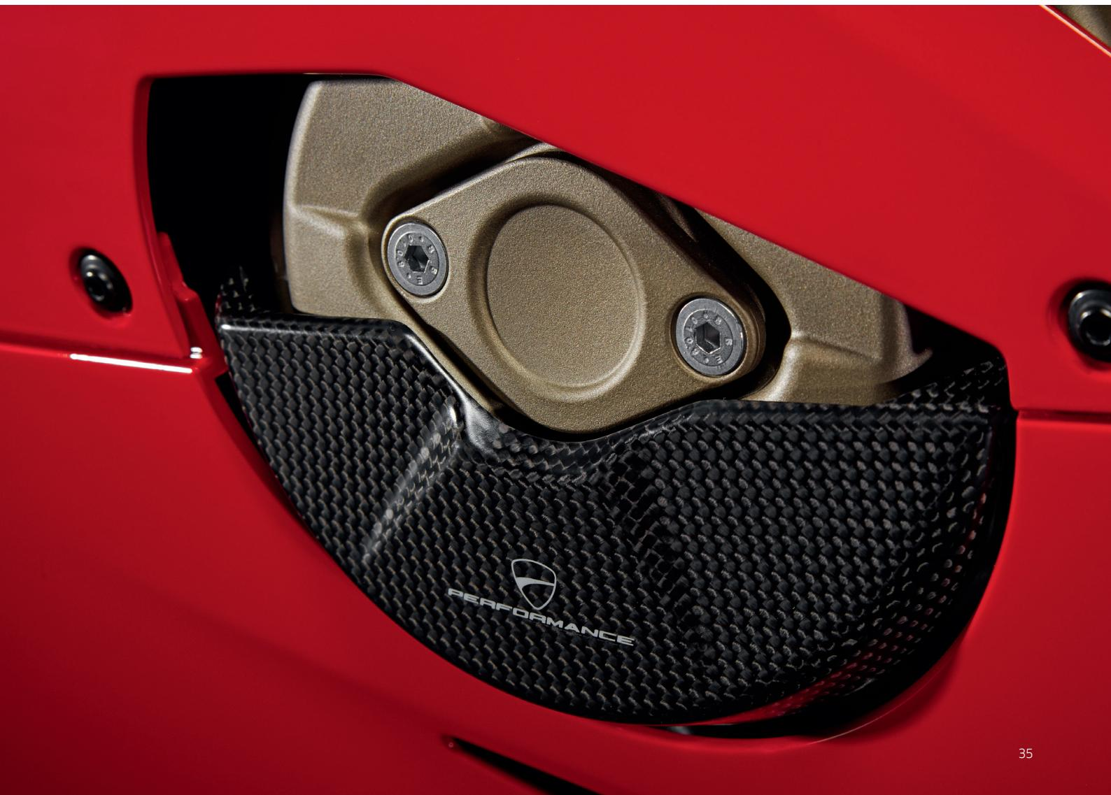
Protezione in carbonio per carter frizione. La leggerezza e la resistenza della fibra di carbonio e fibre aramidiche si uniscono a un design accattivante e a un finishing tipicamente racing in un accessorio che offre la massima protezione in caso di scivolata ed esalta l'animo sportivo ed elegante della Panigale.
