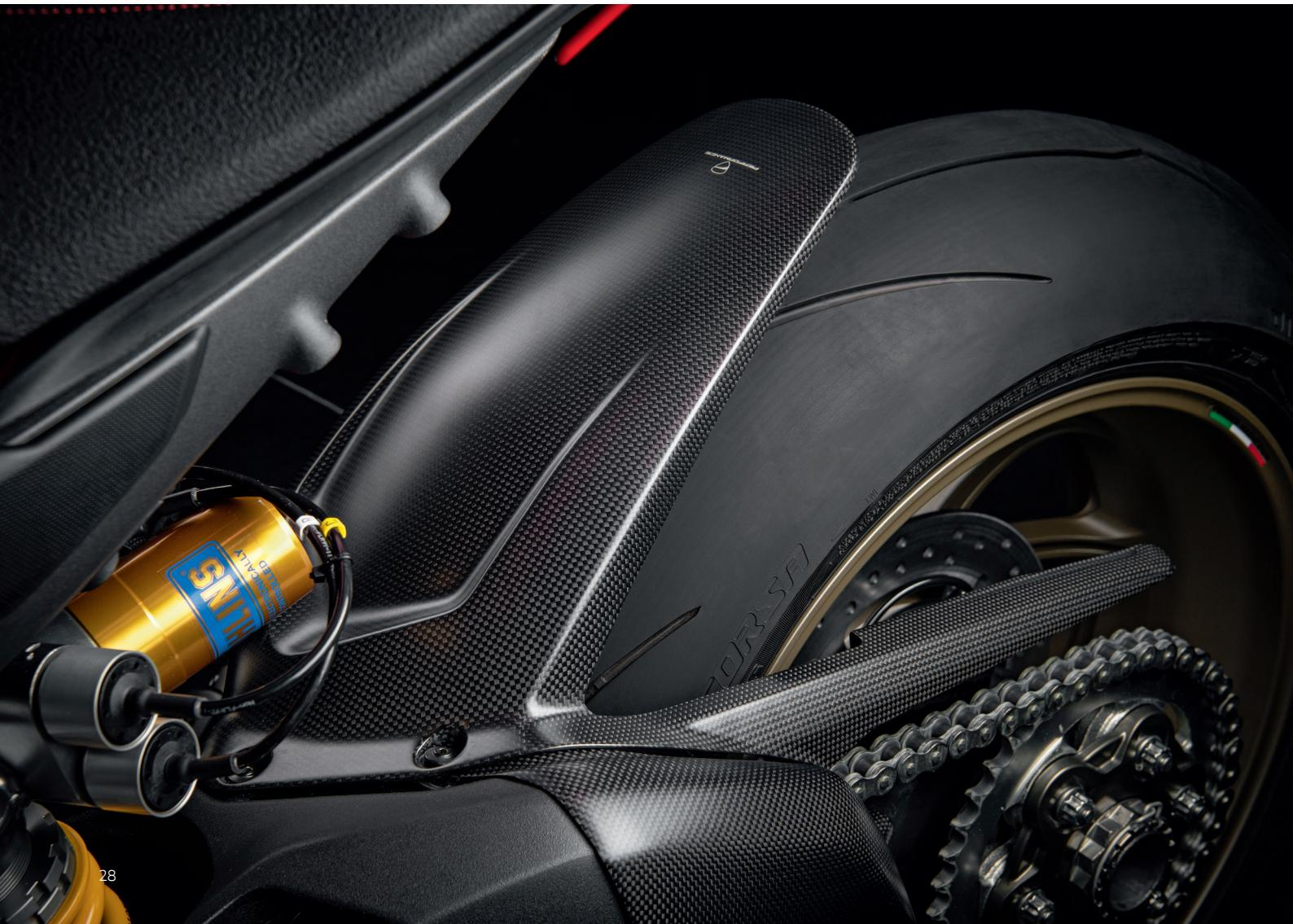
Parafango posteriore in carbonio. Compatibile con l'utilizzo di pneumatici da pista e termocoperte. Design pulito e filante con un'impronta prettamente racing.
