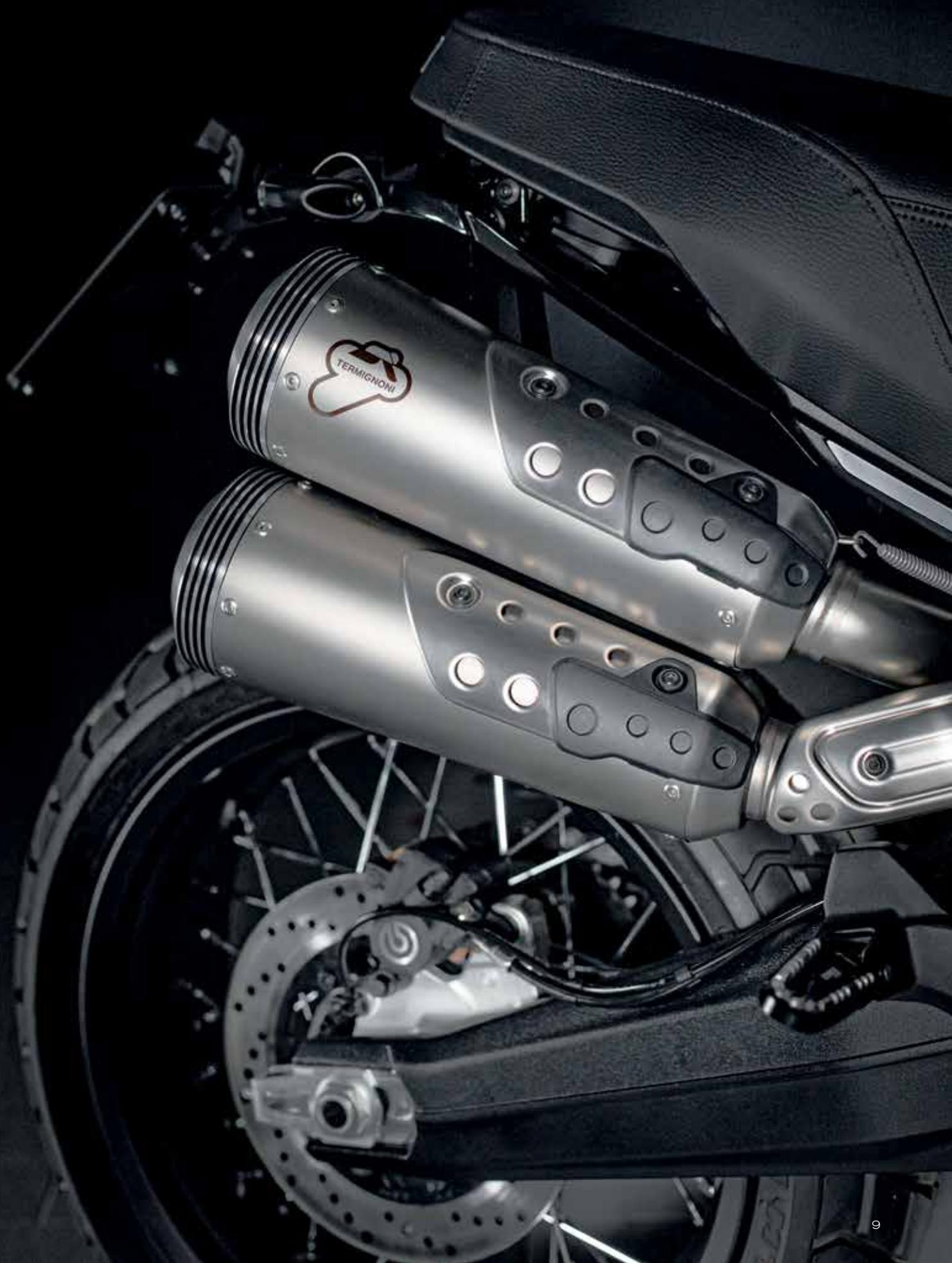
Collettori racing. Creati per la versione Scrambler 1100 e realizzati in acciaio di alta qualità, sono composti da corpo centrale e 2 in 1. In abbinamento ai silenziatori racing migliorano la potenza e l'erogazione del motore. Un dettaglio di stile per una moto iconica.
