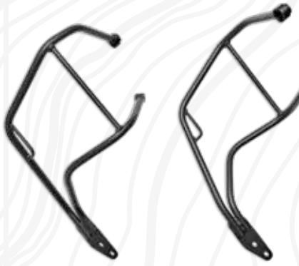
Braçadeira para mala esquerda. Acessório prático que permite a montagem da única mala esquerda nas motos equipadas com escape alto do lado direito, sem ter que adquirir obrigatoriamente o inteiro jogo. Realizada em aço de alta qualidade para manter o aspecto original ao longo do tempo. As suas linhas combinam perfeitamente com o visual urbano da moto.
