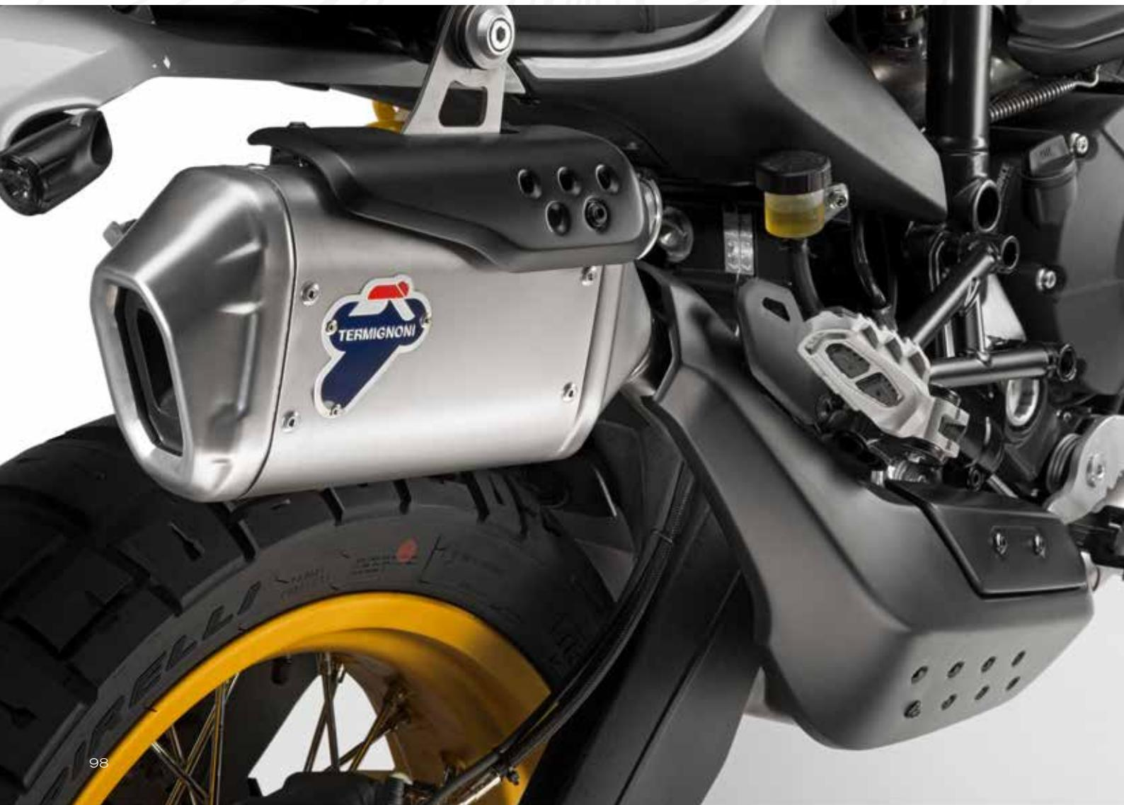
Supporto per gruppo di scarico completo Desert Sled. Insieme di staffe per il montaggio del gruppo di scarico completo sul Desert Sled.
